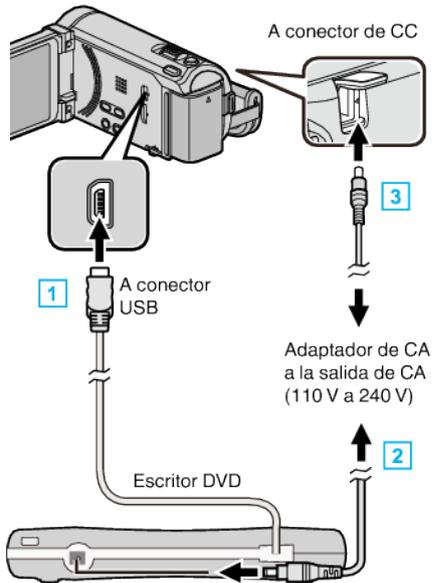
\* El adaptador AC que se muestra en la ilustración es AC-V11U.
