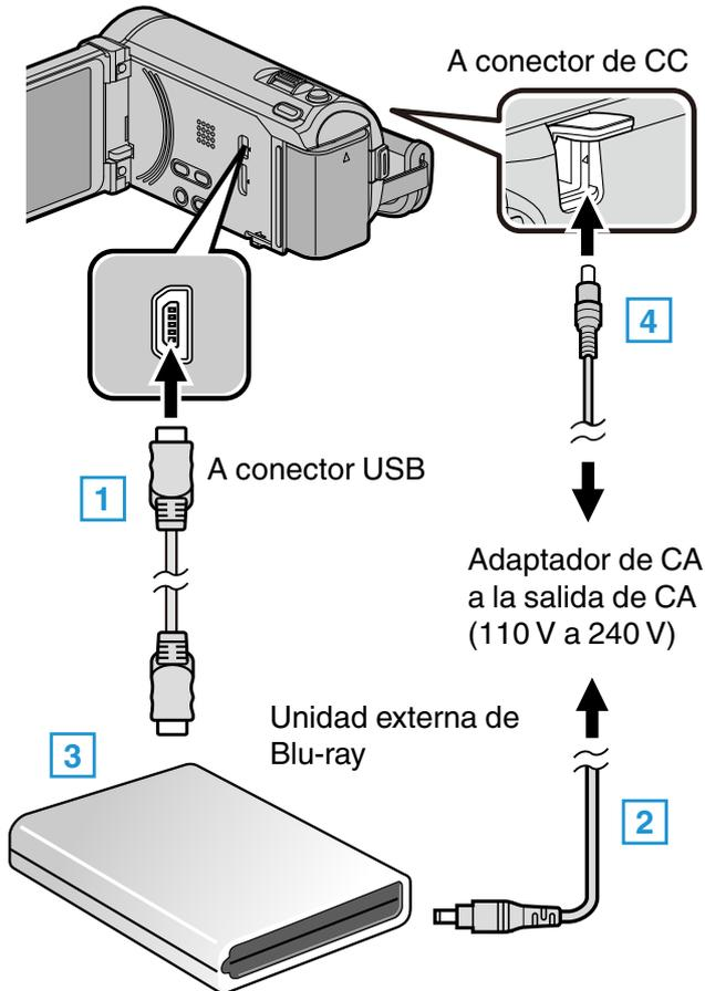
\* El adaptador AC que se muestra en la ilustración es AC-V11U.
