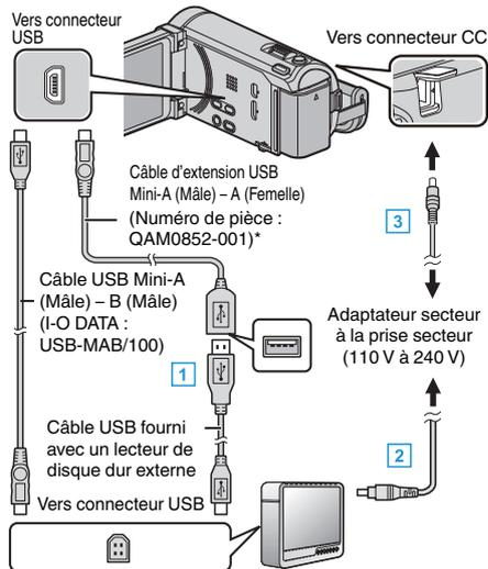
L'adaptateur secteur montré dans l'illustration est le modèle AC-V10M.
