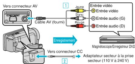
L'adaptateur secteur montré dans l'illustration est le modèle AC-V10M.
