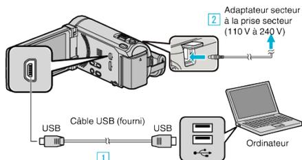
L'adaptateur secteur montré dans l'illustration est le modèle AC-V10M.
