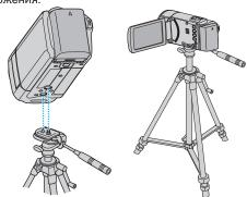
Чтобы избежать падения аппарат со штатива, проверьте отверстия для крепежных винтов на штативе и установочные отверстия на аппарате перед установкой и крепко закрутите винты.
