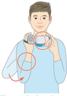
Держите ЖК-монитор левой рукой и по необходимости отрегулируйте угол наклона монитора. Удерживание ЖК-монитора левой рукой помогает стабилизировать камеру во время съемки.
