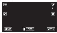
Если режим установлен на интеллектуальный автоматический i.A., нажмите i.A. на экране записи, чтобы отобразить экран переключения режимов.
