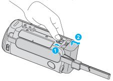
Подвиньте рычажок высвобождения батареи, чтобы снять аккумуляторный блок с аппарат.
