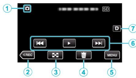
• Cuando la unidad no está siendo accionada, los botones de funcionamiento del monitor LCD desaparecen automáticamente. Pulse en la pantalla para visualizar los botones de funcionamiento nuevamente.
