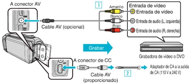
1 Realice la conexión utilizando el cable AV opcional.
