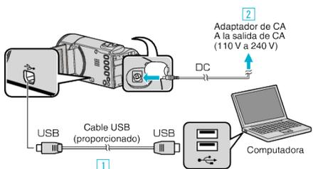
1 Realice la conexión utilizando el cable USB proporcionado.
