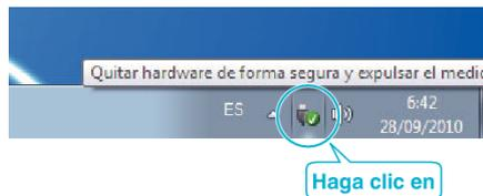
2 Haga clic en "Extracción segura de Dispositivo de almacenamiento masivo USB".
