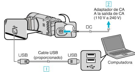
1 Realice la conexión utilizando el cable USB proporcionado.
