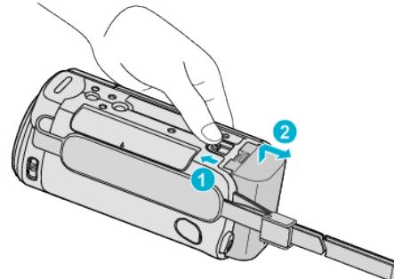
バッテリー取りはずしレバーをスライドさせて、バッテリーをはずしてください。
