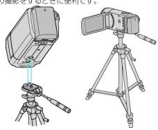
● 落下を防ぐために、取り付け前に本機側の三脚取り付け用のネジ穴と、位 置決め穴の位置をよく確認し、ネジを回してしっかりと取り付けてくだ さい。
