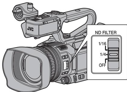
根据物体亮度进行调整。开关位置发生变化时,选定的 ND 滤光片位置会显示在 LCD 显示屏和取景器屏幕上。
