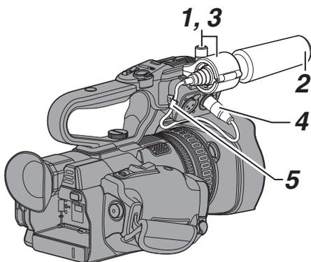
1 朝反时针方向转动话筒座上的旋钮,即可松开并打开话筒座。
