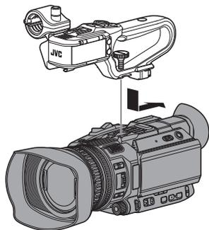
1 将把手装置底部的把手端安装至摄像机顶部的把手装置安装位置。
