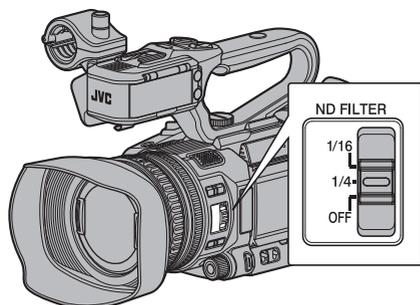
被写体の明るさに応じて切り換えてください。スイッチを切り換えると、LCD モニターやビューファインダー画面に切り換えた ND フィルターのポジションが表示されます。
